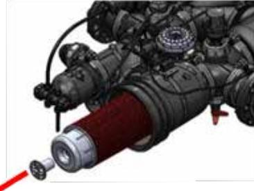
REMOVE THE SPINE CYLINDER LOCATED ON TOP OF THE SPINE.
