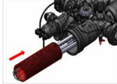
PLACE THE SPINE CYLINDER ON TOP OF THE SPINE.
